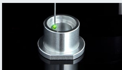
發光處的接觸透過相機檢知
